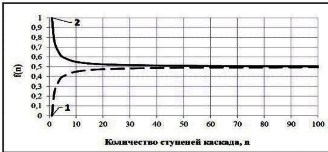
Рис. 2. Зависимость функций f_1 и f_2 от количества ступеней ГЭС: деривационная ГЭС (1) и плотинная ГЭС (2).
