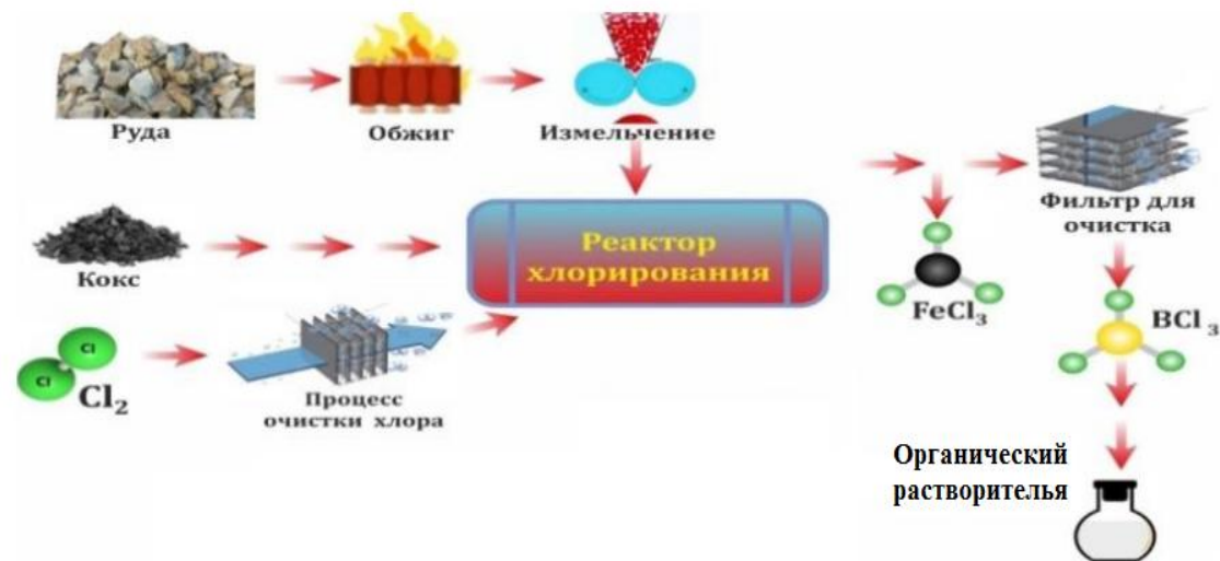
Рис. 3. Схема хлорирования данбурита и датолита.
