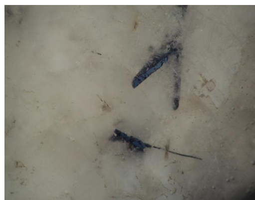
Рис. 2. Кристалл манганокolumбита в кварце. Фото под бинокулярным микроскопом (МБС-2). Ширина поля 3 мм.
