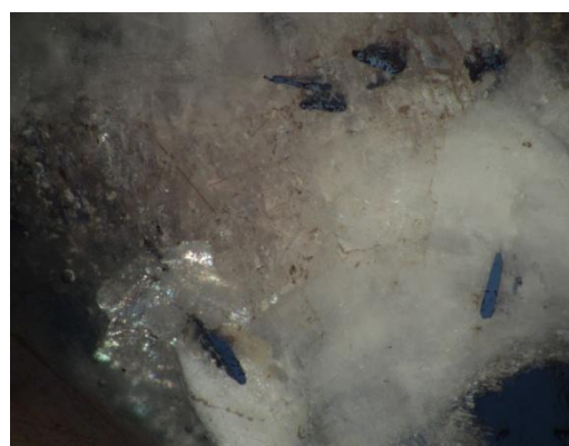
Рис. 3. Длиннопризматические кристаллы маганокolumбита в кварц-альбитовом агрегате. Полированный препарат. Изображения в отраженном свете: а, в – при одном николе; б, г – в скрещенных николях. Ширина поля зрения 5 мм.
