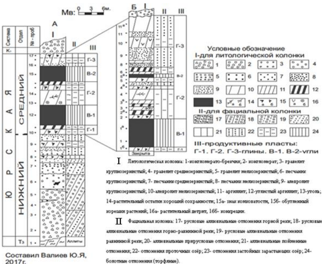
Рис. 1. Разрезы угольного месторождения Зиды, А-северная, Б-южная часть.
