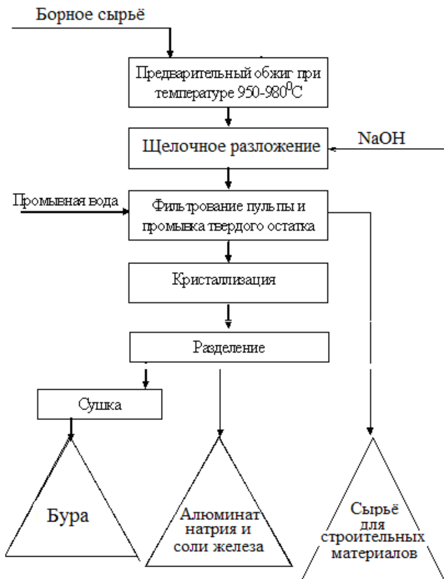
Рис.2. Принципиальная технологическая схема получения полезных компонентов из боросиликатного концентрата разложением щёлочью.
