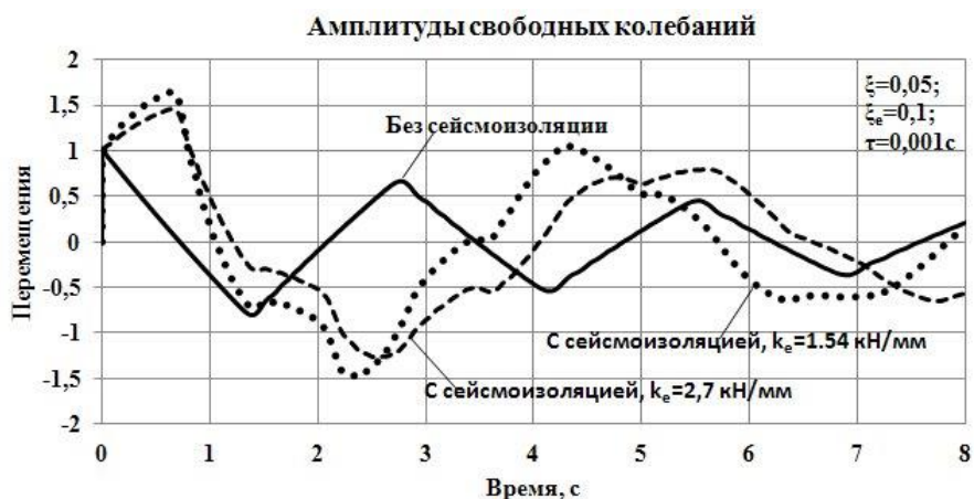
Рис.4. Свободные колебания 30-этажного каркасного здания без сейсмоизоляции и с сейсмоизоляцией при различных значениях k_e .
