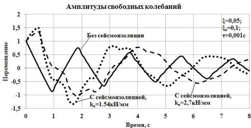
Рис.2. Свободные колебания 20-этажного каркасного здания без сейсмоизоляции и с сейсмоизоляцией при различных значениях k_e .
