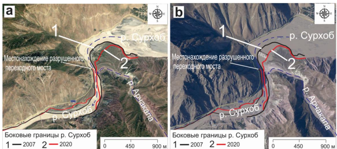
Рис. 8. Селевой конус выноса левого притока р. Сурхоб и её боковые границы на космоснимке с сервиса Google Earth 2007 г. (а) и на аэрофотоснимке, полученном с использованием БПЛА 2020 г. (б).
