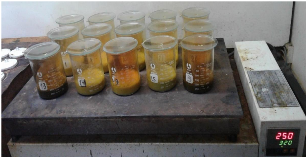
Рис. 1. Растворение и нагревание проб на электронагревательной плите.
