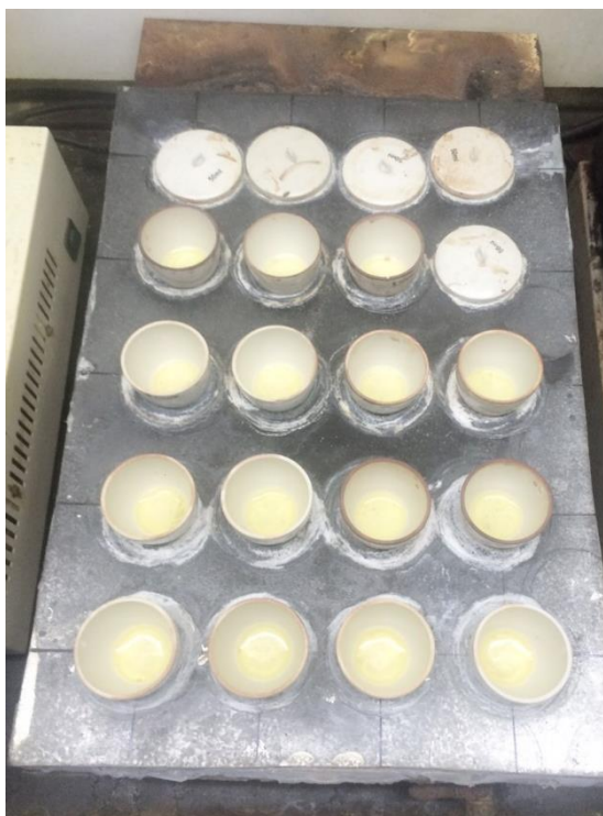
Рис. 4. Растворение в царской водке на водяной бане.
