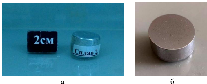
Рис. 1. Сплав №2 (АК7+1 г СВ) а - вид исходного образца; б - образец сплава 2 после полировки.
